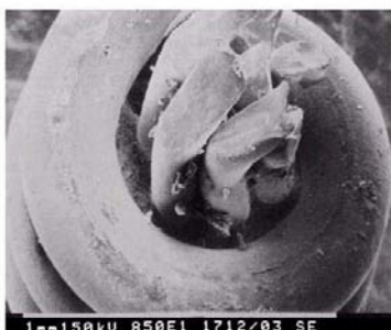
Zbytky organické nečistoty na bioptických kleštích po umytí endoskopu
