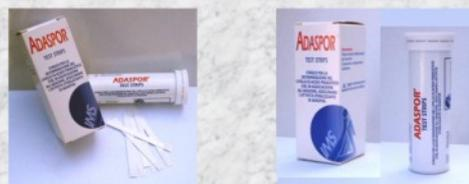
**Adaspor testovací proužky kontrolují minimální koncentraci 500 ppm PAA.**
