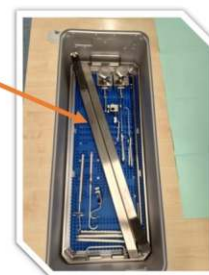
Špeciálna súprava nástrojov na operáciu dutiny brušnej a malej panvy sterilizačný kontajner neštandardnej dĺžky – 750 mm s filtrami na vaničke aj na veku samotné držiaky v dĺžke 72 cm
